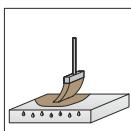
Penetraci pomocí epoxidových výrobků lze provádět i na vlhkých podkladech z betonu. Ušetříme si takto čas, který bychom museli věnovat vysušování podkladu. Zrychlujeme tak investici. Navíc epoxidové výrobky lze aplikovat na přebroušených obkladech a dlažbách, kamenině, teraccu – snižuje to náklady potřebné na demontáž těchto stávajících vrstev.
