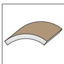
Pro povrchy vystavené působením velkých termických nebo dynamických změn, je vysoká elasticita velmi důležitá. Stejně důležitě je ovšem i uchování těchto vlastností ve velkém teplotním rozsahu. Prodloužení povlaku (nátěru) IZOHAL epoxy EP-602 je 93% (75% při teplotě -10°C). Pro utěsnění IZOHAL epoxy EP-603 je zpětná elasticita dokonce 100%.
