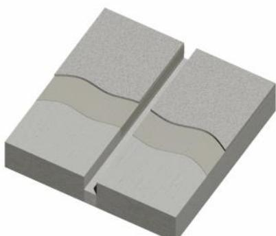
Složky A a B povlaku (nátěru) **IZOHAN epoxy EP-602** se promíchají s křemičitým pískem, přesně dle pokynů uvedených v Technickém listu. Doba použitelnosti smíchaných složek je cca 45 minut. Nanášíme manuálně pomocí zubového hladítka. Po nanesení je třeba povrch srovnat pomocí odvzdušňovacího teflonového válečku s hroty, který nám povlak (nátěr) odvzduší. Technologická přestávka mezi jednotlivými vrstvami je minimálně 24 hodin.
