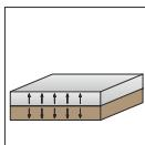
Přídržnost povlaku (nátěru) k podkladu je stěžejní parametr pro trvanlivost zhotovených izolací. Epoxidová penetrace IZOHAL epoxy EP-601 přilne dokonce k mokrému betonovému podkladu a jeho přídržnost je více jak 2,5 MPa. Přilnavost povlaku (nátěru) IZOHAL epoxy EP-602 je dokonce více jak 3,5 MPa.
