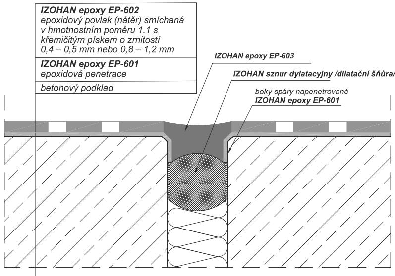
V případě většího pochůzného zatížení, použijeme spáru slícovanou s povrchem (s vodorovnou svrchní plochou) abyhom snížili pravděpodobnost zakopnutí a snadnějšího čištění spáry.
